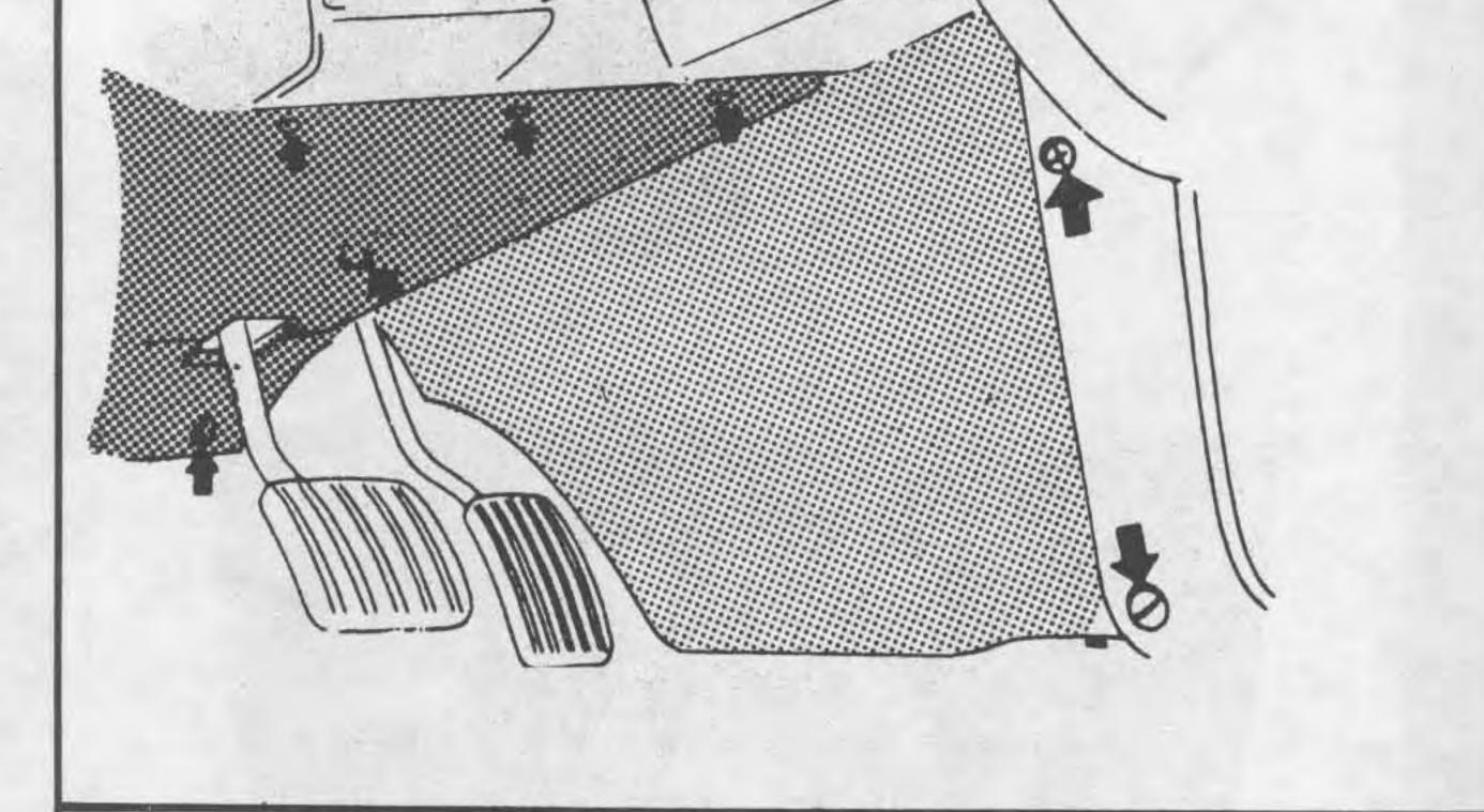
Isolierungsverkleidung unter dem Armaturenbrett lösen und zur Seite schieben. Die Verkleidung gegen die Mittelkonsole hin entfernen.
