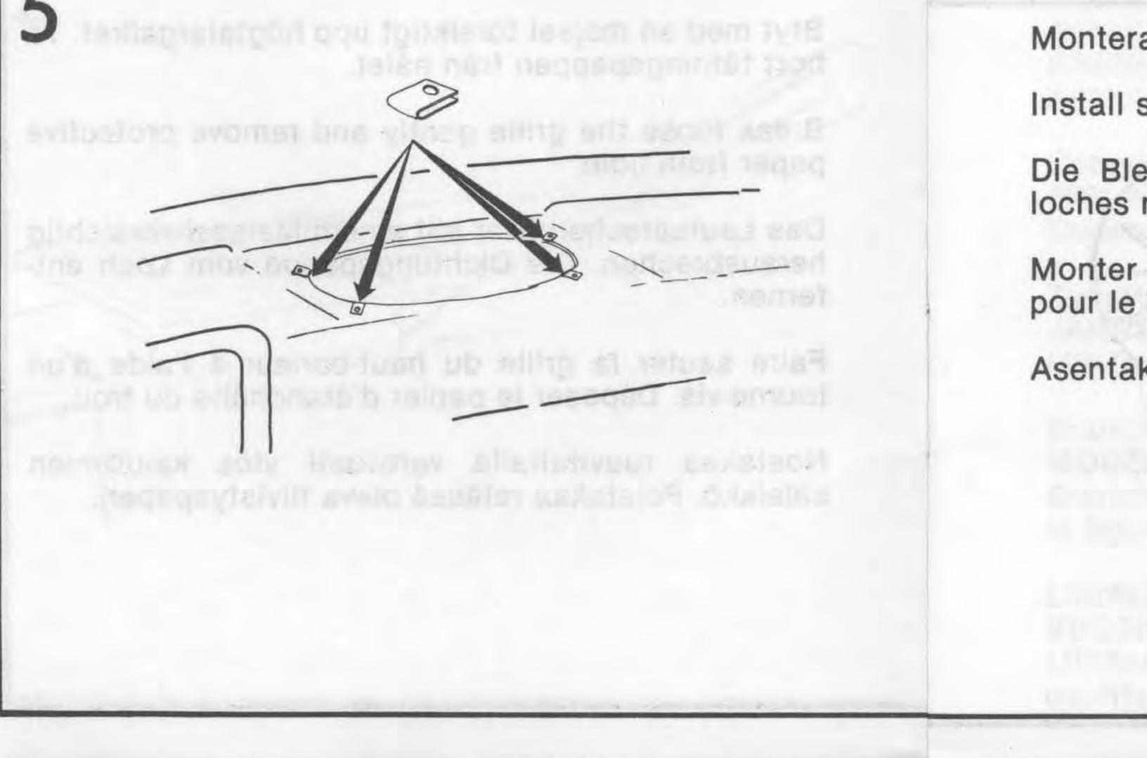
Montera plåtmuttrarna i kanten på högtalarhålet.
