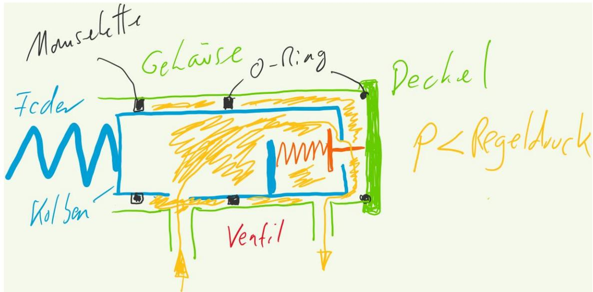
Kolben nach links verschoben...
