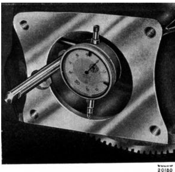
Abb. 19 Messen des Schwunradgehäuses mit der Messuhr
