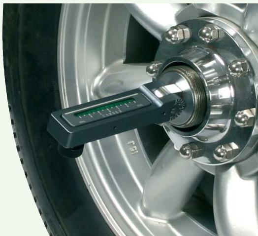
**Messen des Sturzes mit montierten Rädern**
