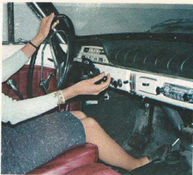
Der Volvo 120 Automatic hat zwei Pedale: Gaspedal und Bremspedal. Auf der Lenksäule befinden sich der Wählerhebel und eine Anzeigtaste.
